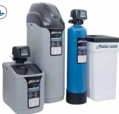
Addolcitori automatici serie AF DIGIT/V (timer con display retro illuminato) a lettura digitale **autodisinfettanti** con rigenerazione a **volume + tempo**. Ad uso potabile. Il nuovo sistema di controllo elettronico delle fasi e la rigenerazione proporzionale permette una riduzione nei consumi di sale. Sono dotati di **miscelatore di durezza** integrato nel corpo valvola.
